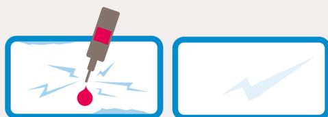
Les bris de vitre sont réparés grâce à **l'injection d'une résine** qui comble les impacts. En cas d'impact trop important, la rame doit être immobilisée et la vitre changée.
