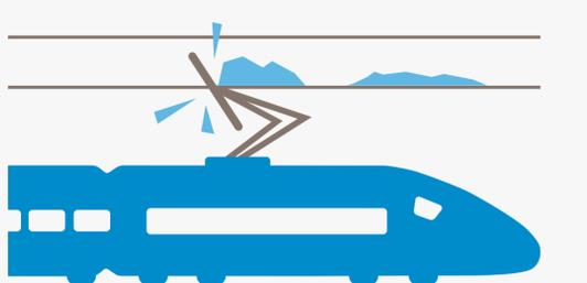
SNCF fait intervenir **des engins équipés de lames racleuses** en acier pour dégivrer les caténaires. Des circuits électriques de réchauffage des caténaires peuvent être activés.
